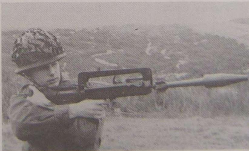
Figure 36. — La visée au fusil lance-grenades avec l'alidade de tir tendu
