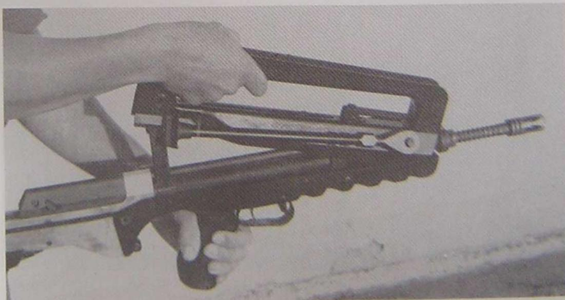
Figure 23. — Pose de la poignée garde-main
