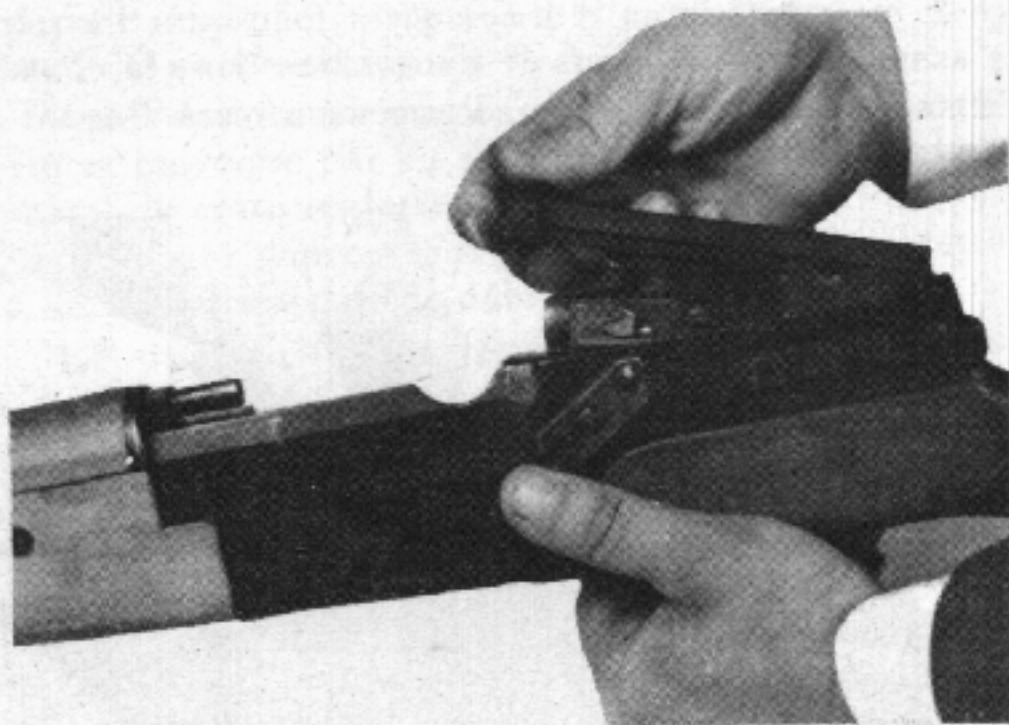
Fig. 6. - Démontage de l'ensemble mobile.
