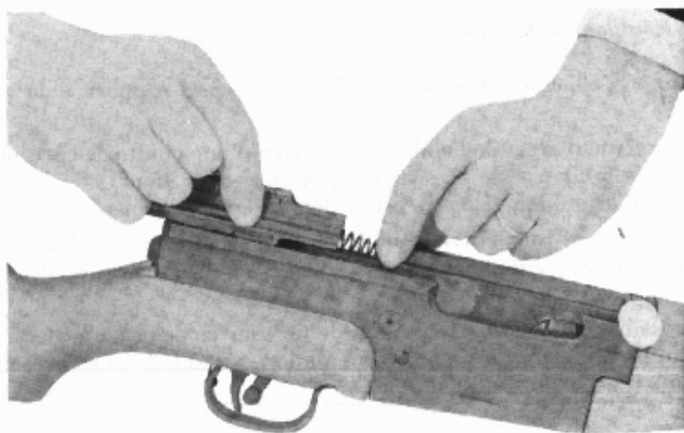
Fig. 15. — Remontage du couvre-culasse
