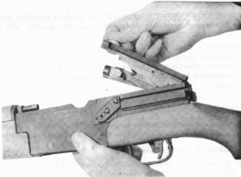
Fig. 14. — Démontage de l'ensemble mobile
