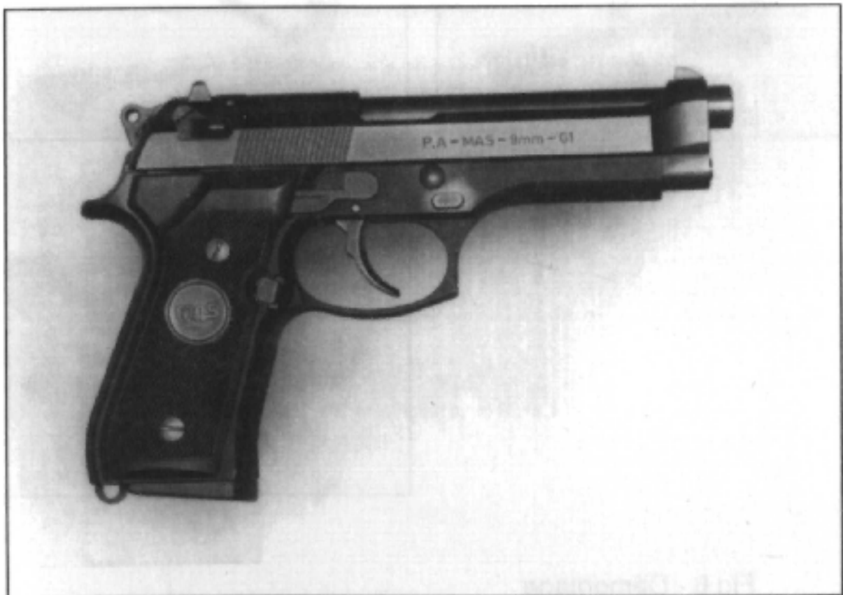
Fig. 4 - Pistolet automatique MAS 9 mm G1 (coté droit)
