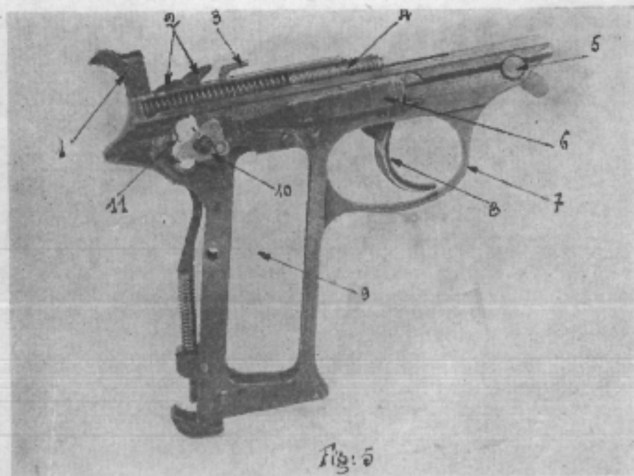
Figure 5. — La carcasse (vue du côté droit)
